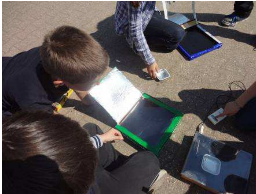
Aus Pizza Kartons wurden kleine Sonnenöfen gebastelt. Die Temperatur erreichte 78°C!
