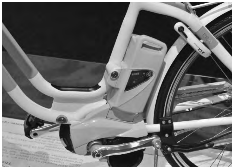
Mittelmotor zum Antrieb über das Tretlager (von Ralf Roletschek).
