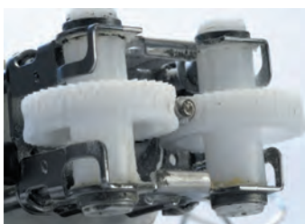
Beispiele für eingebauten Verschleiß – z. B. das Kunststoff-Zahnrad im Handmixer.
