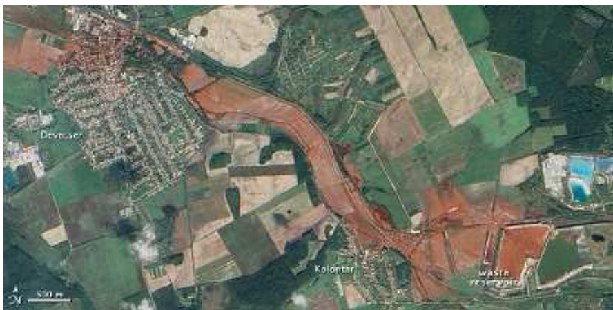
Bild von der Gegend um die Giftschlamm-Ausbreitung in Ungarn. Das Aluminiumwerk erscheint am rechten Bildrand und enthält sowohl leuchtend blaue als auch ziegelrote Auffangbecken. Der Schlamm bildet einen rot-orangefarbenen Streifen, der westlich von der Anlage verläuft. Diese Ansicht zeigt die Ausdünnung, die sich aber über mehrere Kilometer westlich ausbreitet. Foto: NASA
